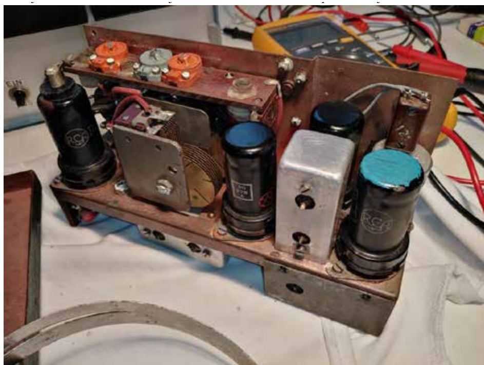
Sl. 13. Prijemnik špijunske radiostanice BP-5 iz Drugog svjetskog rata
