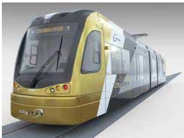
Sl. 28. Moderni niskopodni električni tramvaj s akumulatorima kao dodatnim izvorom napajanja
