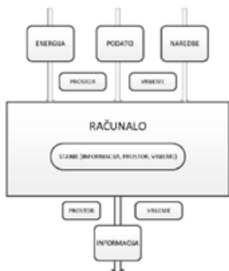
Sl. 1. Blok shema umjetnog, informacijsko-energijskog tehničkog sustava
