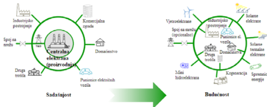
Slika 11. Usporedba klasičnog centraliziranog sustava s decentraliziranim sustavom [7]
