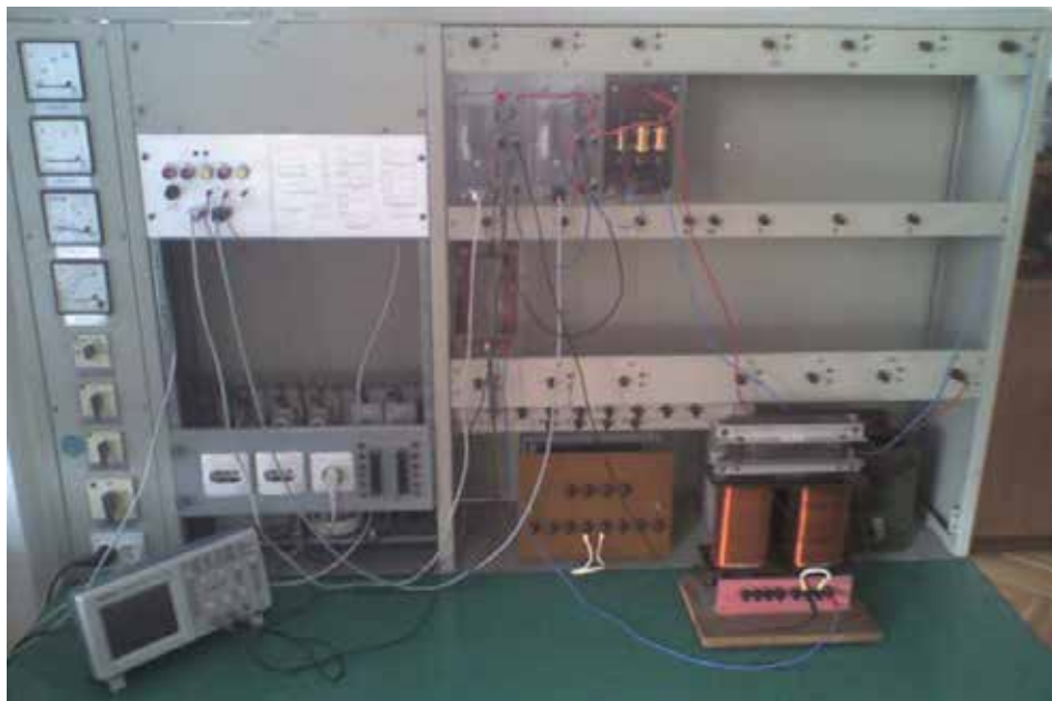
Slika 6. Pult za modeliranje sklopova energetske elektronike razvijen u KONČAR-u
