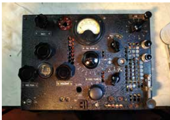
Sl. 4. Prednja ploča BP-5 nakon kupnje i prvog detaljnog čišćenja
