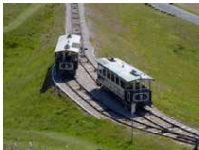
Sl. 25. Tramvaj s pogonom vučnim užetima, Llandudno (Wales, UK)
