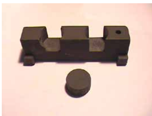
Slika 8. Lađica za legiranje i „sendvič“ diode
