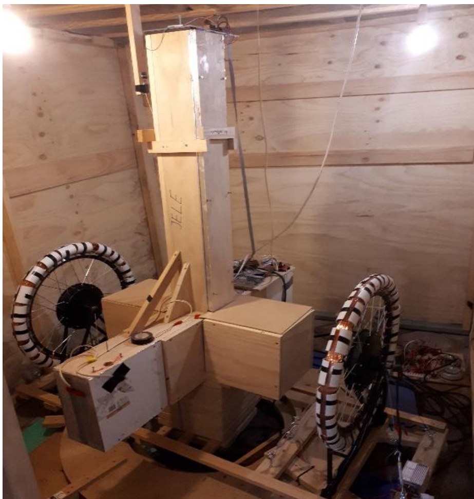
Sl. 8.: Model instrumenta za mjerenje dinamičkog gravitacijskog polja
